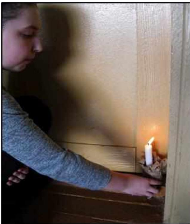
*Фото 3. Определение воздушных потоков через двери в кабинет*
